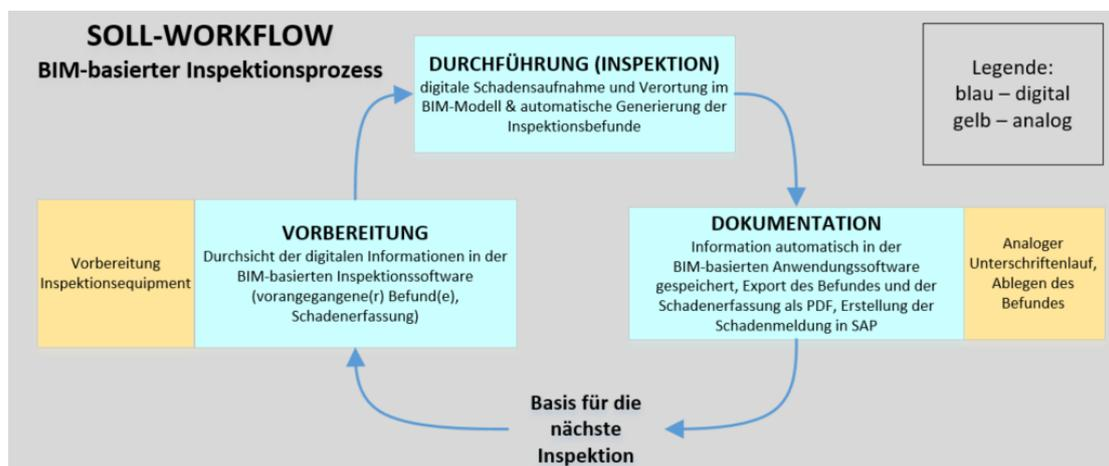
Abbildung 2. BIM-basierter SOLL-Prozess der Brückeninspektion
